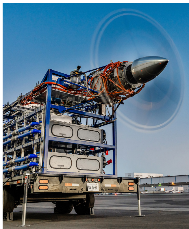
Universal Hydrogen社のパワートレインのプロトタイプが、屋外に設置された実物大のアイアンボードでテストされ、設計を検証するための運転データが収集されます。
